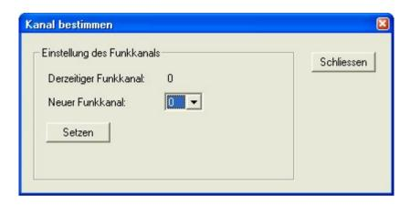
Unter "Derzeitiger Funkkanal" ist der aktuelle Kanal angezeigt. Über "Setzen" kann der Funkkanal geändert werden.
